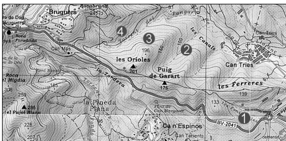
Figura 2. Localització de les diverses explotacions de ferro de les que en quedes restes: (1) explotació a cel obert, probablement corresponent als treballs del segle XVIII. (2) i (3) Mines al vessant del Puig Garart i al vessant de les Orioles, possiblement corresponent a les reobertures de 1856-1879. (4) Mines de Rocabrúna, possiblement corresponents al període 1940-1959.
